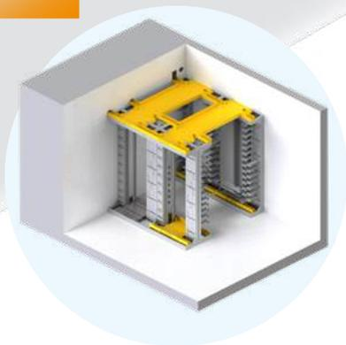
Eine PoP-Station\* ist eine Technikzentrale und stellt das Herzstück in der kommunalen Breitband-Infrastruktur dar: In ihr werden die Verbindungen für Daten- und Sprachverkehr zusammengeführt. Die PoP-Station fungiert als Knotenpunkt zwischen dem Weitverkehrsnetz (WAN = Wide Area Network) und dem regionalen FTTH-Glasfasernetz, welches bis zu jedem einzelnen Hausanschluss führt.
