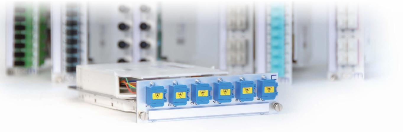
**Application** Les modules à fusionner 3U permettent l'installation des tubes de fibre optique dans les châssis 4U. Leur construction modulaire facilite leur mise en place et toute intervention postérieure. La réserve des sur-longueurs des câbles se range en dessous du châssis.
