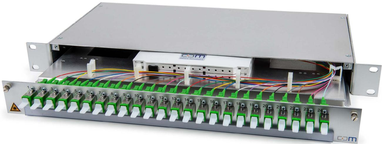
**Application** Le panneau de brassage à fusionner PRO permet le raccordement des câbles en tube de séparation (Loose Tube). Le panneau de brassage PRO se compose d'un tiroir autobloquant qui se tire vers l'avant puis s'incline à 35°: cela facilite l'installation et le travail de maintenance. Les surlongueurs des tubes de protection du câble se trouvent sur le dessous du tiroir.
