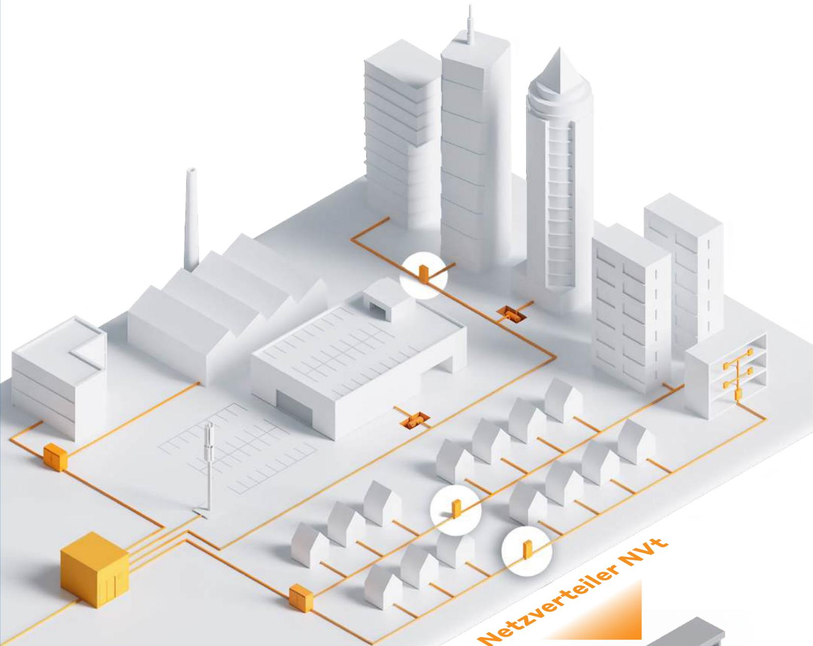
Netzverteiler sind passive Verteilergehäuse für den Glasfaser-Netzausbau und werden zur Verzweigung von Glasfaserkabeln auf Endteilnehmeranschlüsse eingesetzt. Sie kommen sowohl in P2P- als auch in PON-Architekturen zum Einsatz und ermöglichen es, Glasfaserkabeln in unterschiedlicher Anzahl an Endabnehmer in Wohn- und Industriegebieten zu verzweigen.
