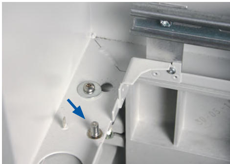
7A Position des Bolzens zur Befestigung der Erdungsklemme im Zwischensockel. Material: NVt Erdungsklemme A2 für Rundleiter Ø 6- 12 mm Set (Art.Nr. 970135)
