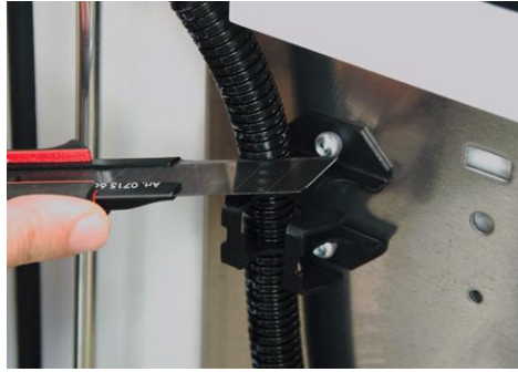
3F Flexschlauch 10 mm oberhalb der Halterung abschneiden. Tipp: Um Bündeladern einfacher einführen zu können, Flexschlauch demontieren und gerade auslegen. Anschliessend Flexschlauch gemäss Montageanleitung wieder einbauen. Werkzeug: Cuttermesser
