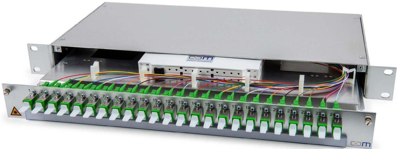
**Application** Le panneau de brassage à fusionner PRO permet le raccordement des câbles en tube de séparation (Loose Tube). Le tiroir autobloquant se tire vers l'avant puis s'incline à 35°: cela facilite l'installation et le travail de maintenance. Les surlongueurs des tubes de protection du câble se trouvent sur le dessous du tiroir.
