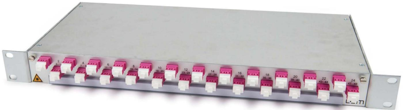
**Application** Le panneau de brassage à fusionner permet le raccordement des câbles en tube de séparation (Loose Tube). Le tiroir autobloquant se tire vers l'avant puis s'incline à 35°: cela facilite l'installation et le travail de maintenance. Les surlongueurs des tubes de protection du câble se trouvent sur le dessous du tiroir.
