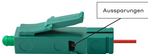
Das Verriegelungsgehäuse mit dem Schlitz über das Kabel und nach vorne gegen das LC-Gehäuse drücken bis die zwei seitlichen Haken in den Aussparungen einrasten.
