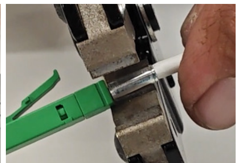
11B 180 Grad drehen und erneut krimpen.
