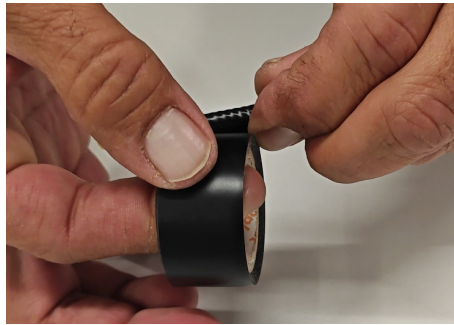
1A Den Strumpf mit dem Klebenband fest am Kevlar befestigen.
