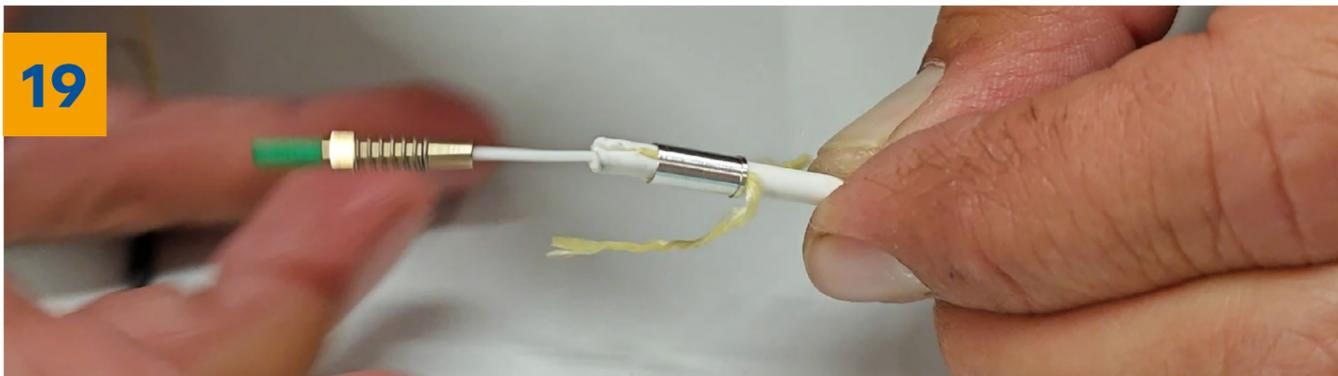
Das Kevlar wird in Richtung des Kabels angelegt und der Knickschutz mit der schmalen Seite voran vorsichtig darübergezogen. Anschliessend schiebt man die Krimphülse mit der umrandeten Seite voran über das Kabel.
