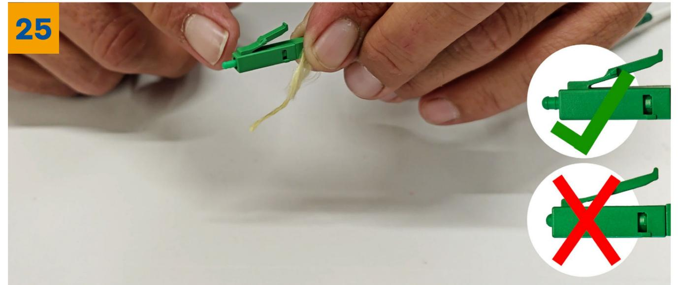
Nach dem Anbringen des Krimpkörpers wird das Steckergehäuse mit dem Hebel nach oben montiert.
