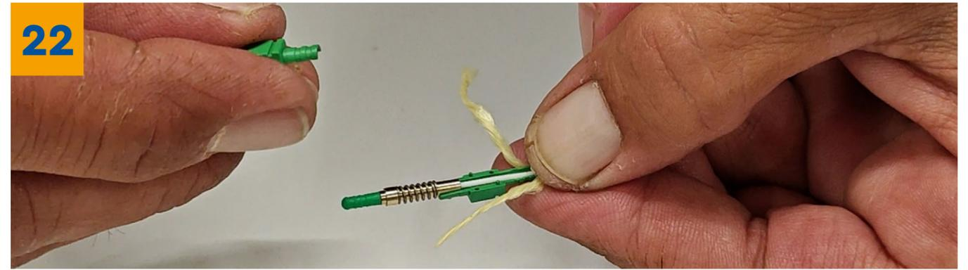
Nun wird der Krimpkörper angebracht. Dazu legt man zuerst die erste Hälfte mit der gerillten Seite in Richtung Kabel und der glatten Seite bis zur Feder an, und drückt danach die zweite Hälfte in der gleichen Richtung darauf.
