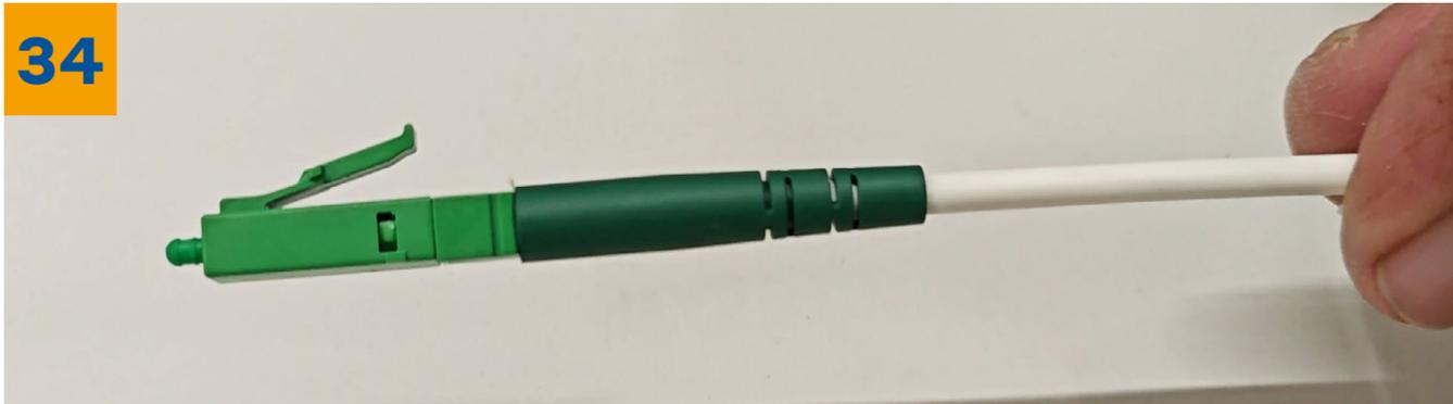
Die Krimphülse wird einmal mit der [Krimpzange](#) gekrimpt, dann um 180 Grad gedreht und erneut gekrimpt. Anschließend wird der Knickschutz darüberschoben.
