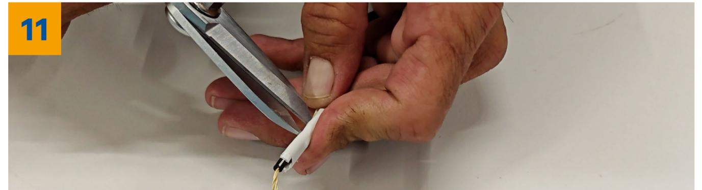
In diesem Schritt wird der weisse Schrumpfschlauch vorsichtig vom Kabelmantel entfernt.
