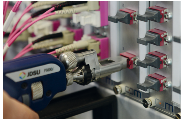
Image : Embout MTP/MPO APC pour sonde microscopique
